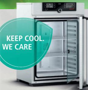
Die Feuchtekammer HCP ist der schlanke Klimaschrank mit voller Leistung bei Zuverlässigkeit, Sicherheit und Komfort. Ideal für Lebensdauertest und 85/85-Test.
